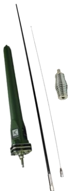
Части антенны 9350 (основной узел, штырь из стекловолокна, штырь из нержавеющей стали и пружина)
